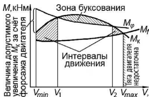
Рис. 1.6. Характеристика проходимости автомобиля на i -ой передаче
